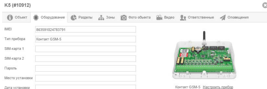
Рисунок 8. Настройка прибора через GEO.RITM
