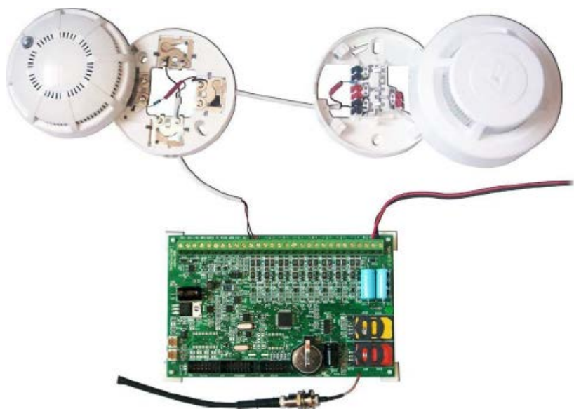
Рисунок 45. Фотография подключения двух пожарных датчиков
