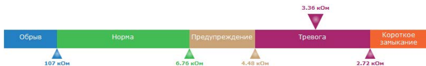
Рисунок 20. Шкала порогов пожарного шлейфа
